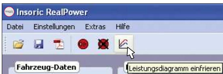
Nach der Auswertung einer Messfahrt können die Messkurven im Leistungsdiagramm fixiert (eingefroren) werden. Diese Funktion eignet sich zum Vergleich der Messkurven von zwei verschiedenen Messungen. Klicken Sie dazu zuerst auf das entsprechende Icon, um die Messkurven einzufrieren.
