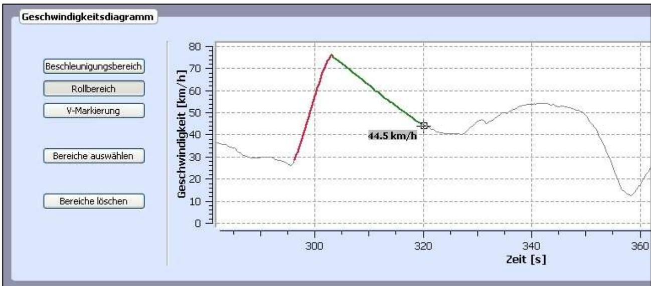
Klicken Sie nun im Menü "**Geschwindigkeitsdiagramm**" auf die Taste "**Rollbereich**". Setzen Sie den Cursor (Kreuz) an den Beginn des zu markierenden Rollbereichs und bestätigen Sie diesen Punkt mit einem Klick der linken Maustaste. Setzen sie nun den Cursor ans Ende des zu markierenden Bereichs und klicken Sie erneut mit der linken Maustaste. Der Rollbereich wird nun grün eingefärbt. Die Markierung wird damit abgeschlossen.
