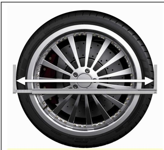
Die Messung des Raddurchmessers wird in horizontaler Lage vorgenommen, da hier in jedem Fall der erforderliche Raum zwischen Rad und Radkasten vorhanden ist.
