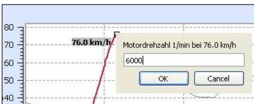
Es öffnet sich nun automatisch ein Fenster in dem die Motordrehzahl, welche bei der ausgewählten Geschwindigkeit vom Drehzahlmesser abgelesen wurde, eingetragen werden kann.
