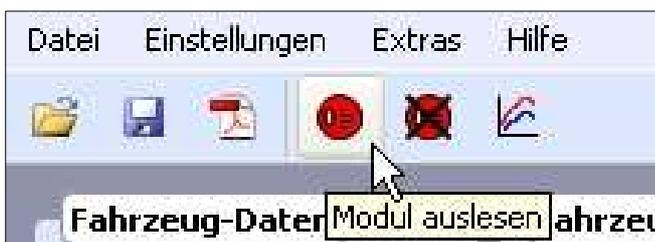
Aktivieren Sie das RealPower-Modul über das Icon "**Modul auslesen**". Der Übertragungsvorgang, bzw. das Auslesen der Daten wird nun gestartet.
