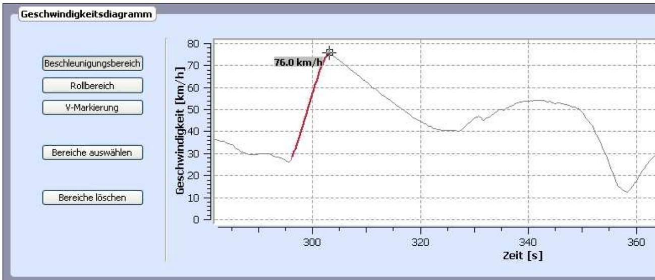
Klicken Sie nun im Menü **"Geschwindigkeitsdiagramm"** auf die Taste **"Beschleunigungsbereich"**. Setzen Sie den Cursor (Kreuz) an den Beginn des zu markierenden Beschleunigungsbereichs und bestätigen Sie diesen Punkt mit einem Klick der linken Maustaste. Setzen Sie nun den Cursor an das Ende des zu markierenden Bereichs und klicken Sie erneut mit der linken Maustaste. Der Beschleunigungsbereich wird nun rot eingefärbt. Die Markierung wird damit abgeschlossen.
