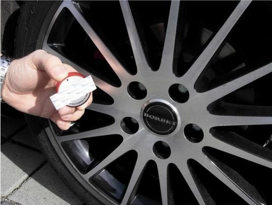
Die Befestigung des RealPower-Moduls ist sehr einfach: Lösen Sie eine der Schutzfolien des Befestigungssystems und fixieren Sie es auf der Rückseite des RealPower-Moduls (*Seite mit Insoric-Logo*). So bleibt der Blick auf die LED-Anzeige frei.
