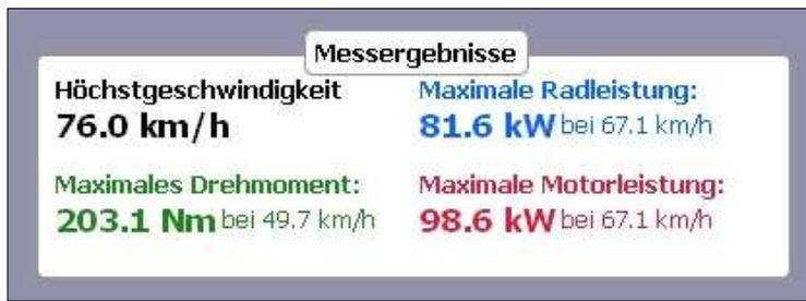
Wurden die fahrzeugspezifischen Parameter sowie die Beschleunigungs- und Rollbereiche korrekt angegeben, werden nun die Leistungswerte als Maximalwerte ...
