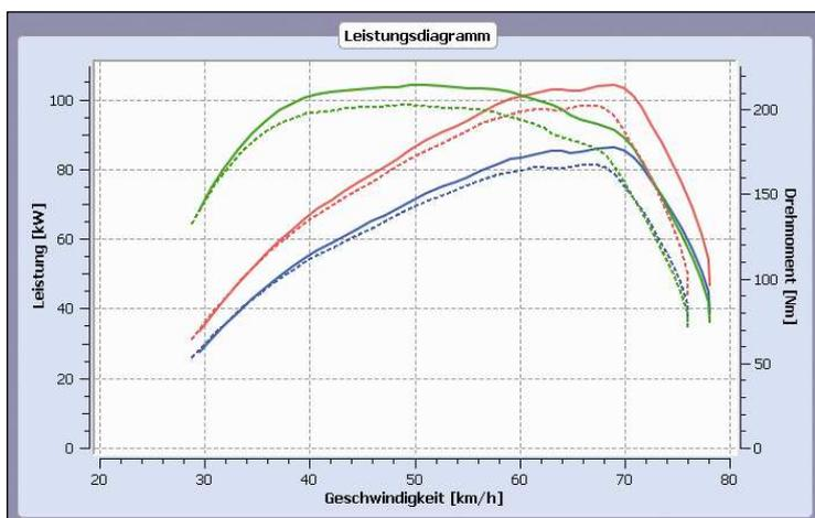
Anschließend öffnen Sie eine andere, bereits abgespeicherte Messung. Das Leistungsdiagramm kennzeichnet nun die eingefrorene Messung mit unterbrochenen und die neu geladene Messung mit ausgezogenen Kurven. Auf diese Weise können zwei verschiedene Messungen miteinander verglichen werden.
