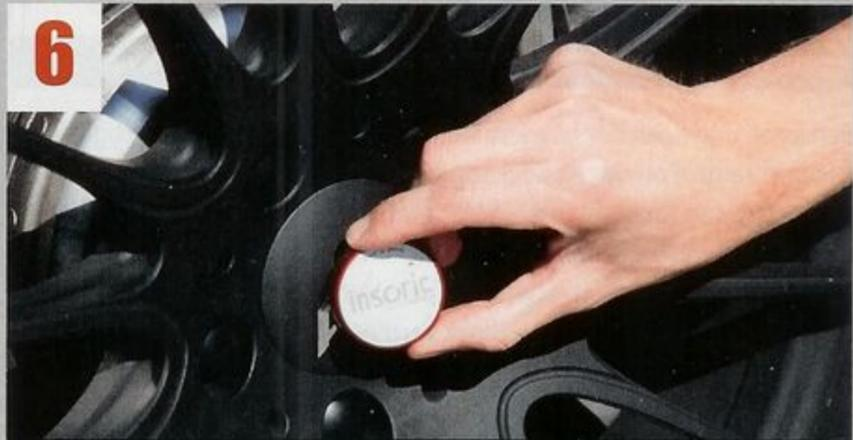
Jetzt klebt man das RealPower Modul an die Nabenverkleidung eines Rads.
