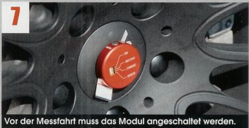
Vor der Messfahrt muss das Modul angeschaltet werden. Nach der Messfahrt überträgt man die Daten per USB.
